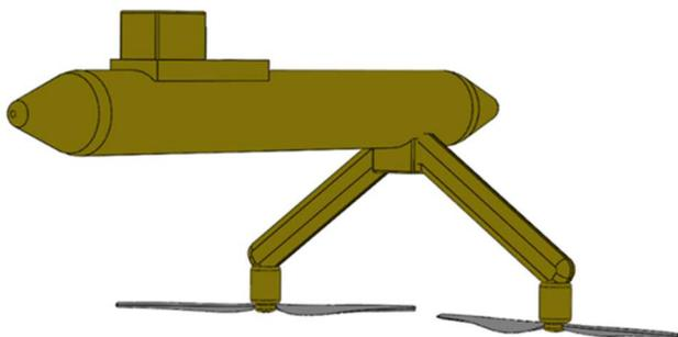
Fig. 17. Waveco turbines directly coupled to a float.
